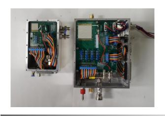
2次元CdTeフォトンカウンティング検出器 WERPAD (Wide Energy Range Pixel Array Detector) は3種までのエネルギー弁別が可能なフォトンカウンティング回路を搭載した次世代型エックス線・ガンマ線カメラで、アルミショットキー型CdTeセンサーを用いることにより、高い時間安定性、優れたエネルギー分解能、高精細画像を実現しました
